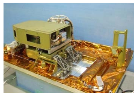
REX-J のロボット本体 (MCE に搭載される前の状態) (出典: JAXA)
