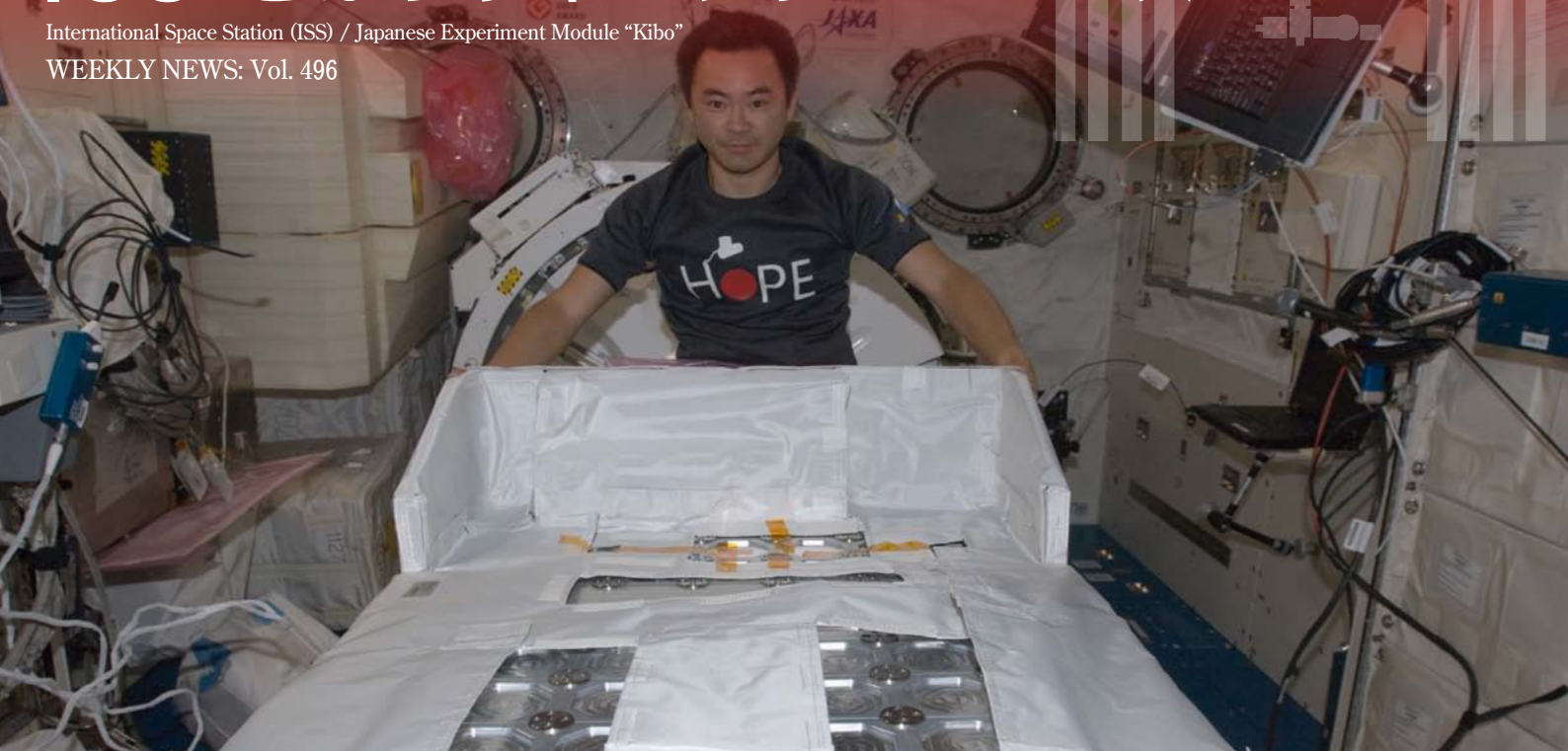
星出宇宙飛行士と小型衛星放出機構 (J-SSOD) の親アーム先端取付型プラットフォーム (MPEP) (出典: JAXA/NASA)
