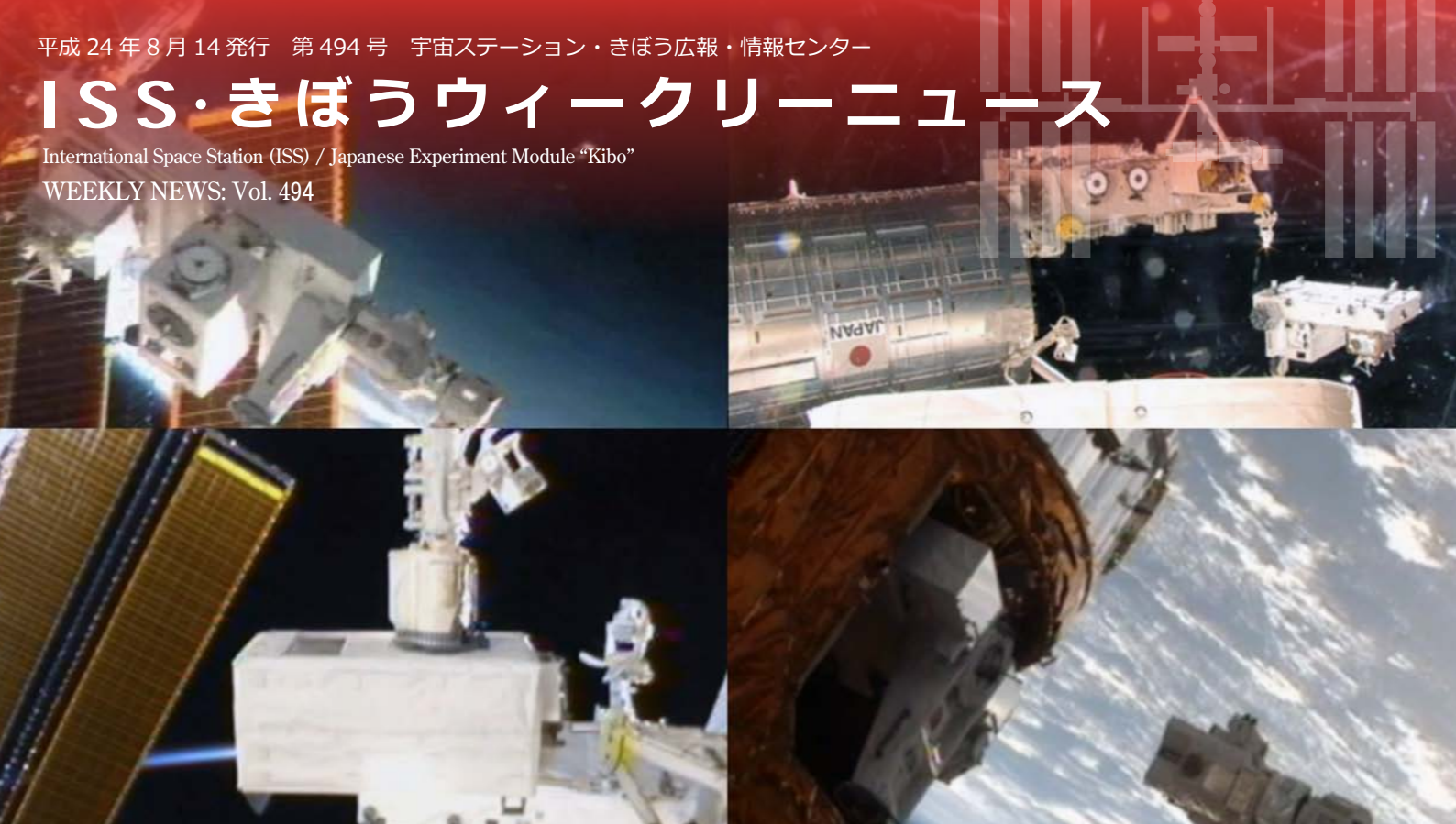
(左上)「こうのとり」3号機から取り出された曝露パレット (右上)「きぼう」船外実験プラットフォームに移設される曝露パレット (左下)「きぼう」船外実験プラットフォームに移設される MCE (右下)「こうのとり」3号機に戻された曝露パレット (すべて出典: JAXA/NASA)
