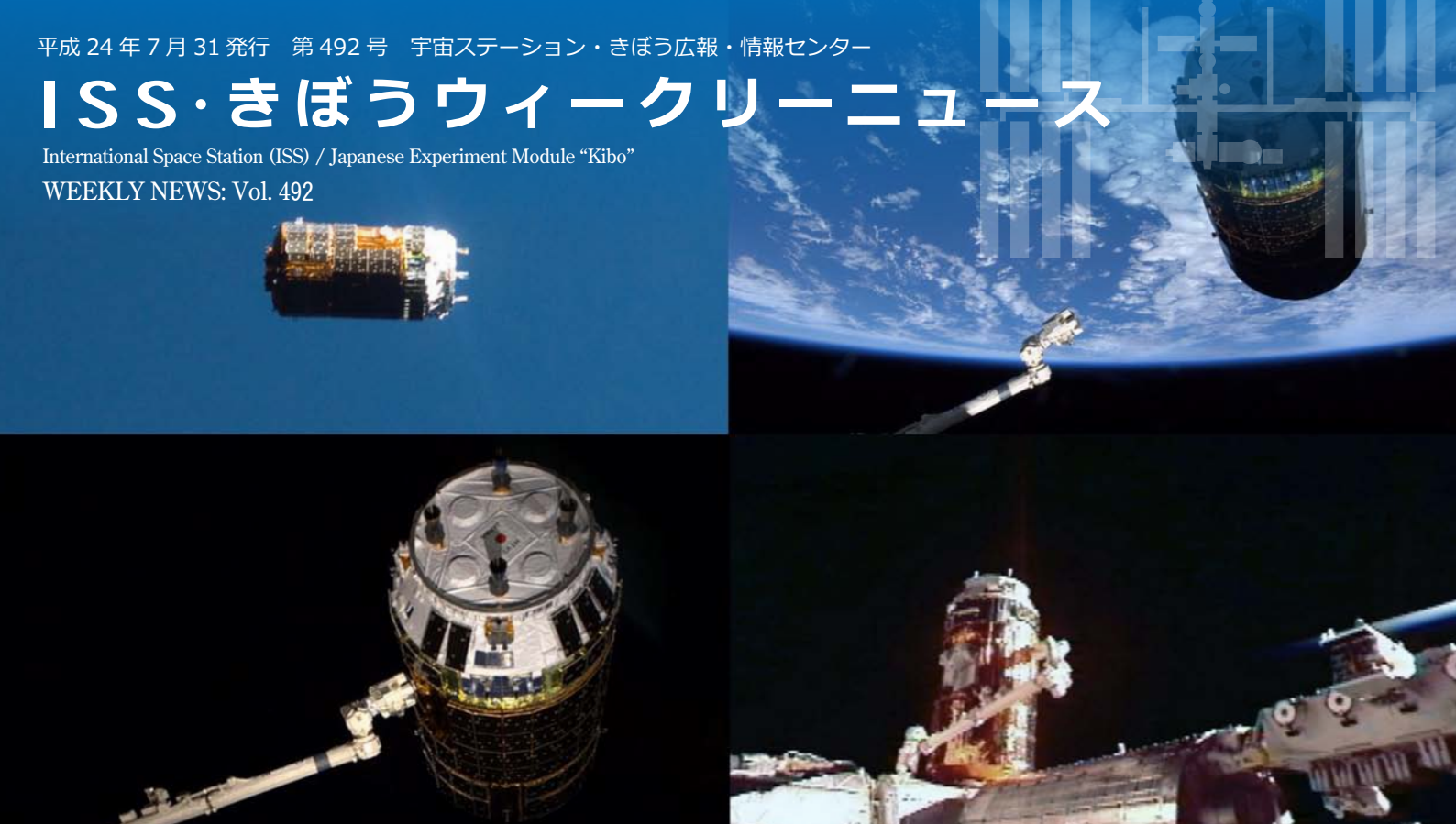
(左上) ISSへ接近する「こうのとり」3号機 (右上)「こうのとり」3号機を把持するため接近するISSのロボットアーム (SSRMS) (左下) SSRMSに把持された「こうのとり」3号機 (右下) SSRMSによりISSへ取り付けられた「こうのとり」3号機 (すべて出典: JAXA/NASA)
