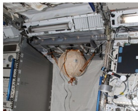
「きぼう」船内実験室に設置されたマトリョーシカ -R 球体ファントム (出典: JAXA/FSA)
