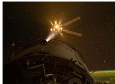
ATV3のスラスタ噴射の様子(ISSへのドッキング時)(出典: JAXA/NASA)
