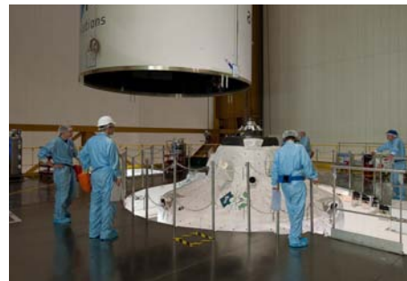
フェアリングに再格納される ATV3 (出典: ESA/CNES/Arianespace/Optique Video du CSG-P.Baudon)
