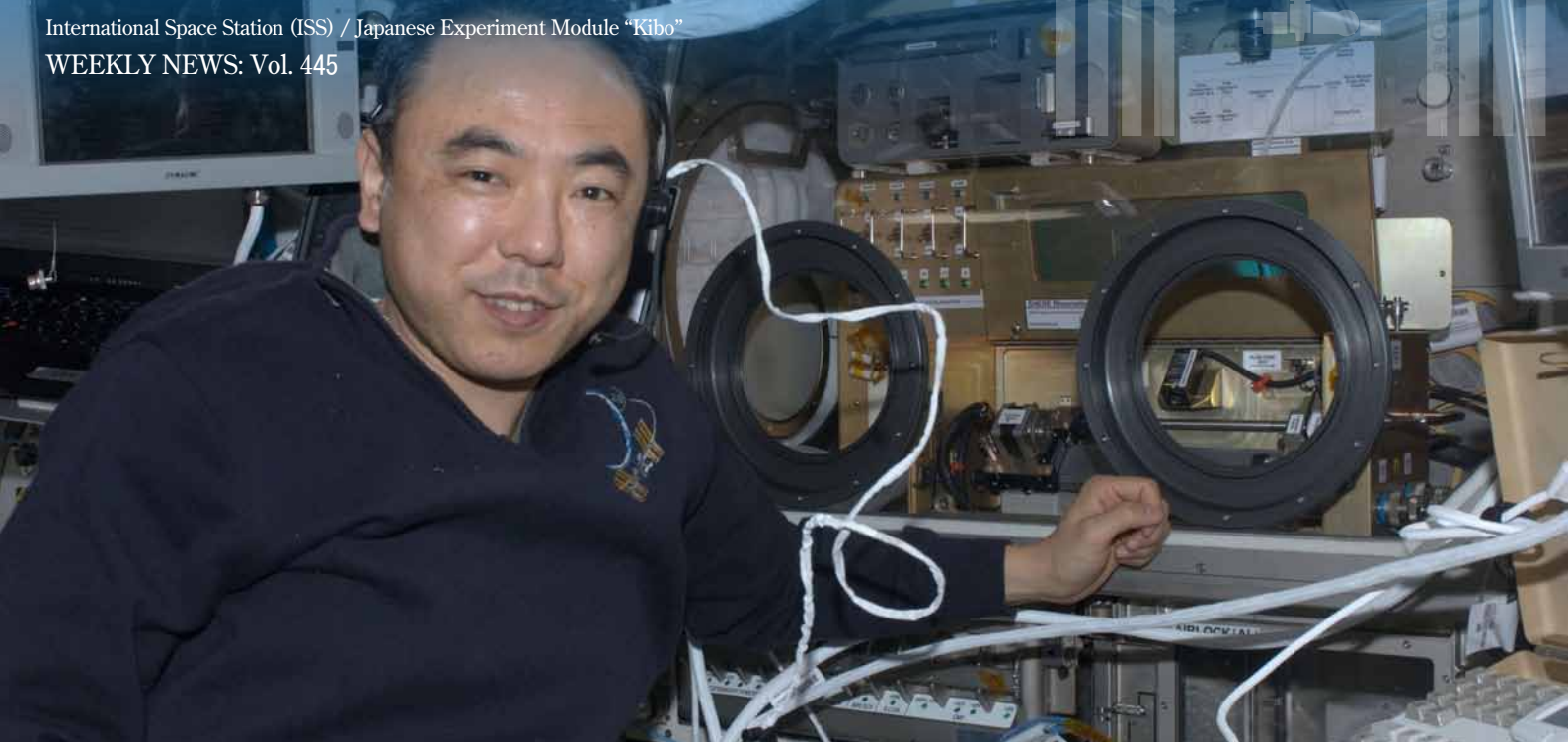
引張時のせん断応力に関する米国の研究 (SHERE) 実験装置の入った微小重力研究グローブボックス (MSG) と古川宇宙飛行士 (出典: JAXA/NASA)
