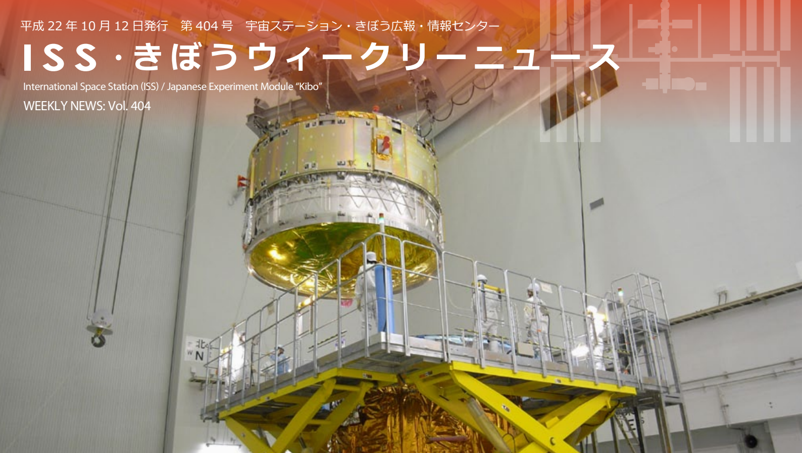
宇宙ステーション補給機 (HTV) 2号機の補給キャリア与圧部と補給キャリア非与圧部の結合の様子 (出典: JAXA)
