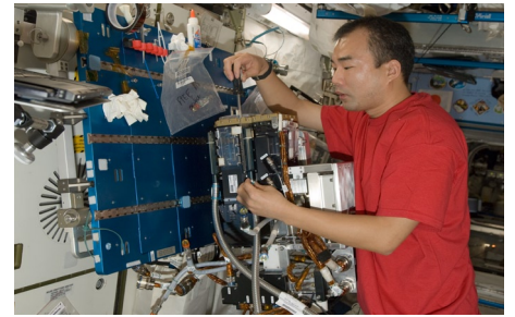
マランゴニ対流実験の供試体の補修作業を行う野口宇宙飛行士 (1月15日) (提供: NASA)
