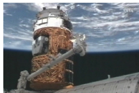
SSRMS により ISS へ取り付けられる HTV 技術実証機 (提供: NASA)
