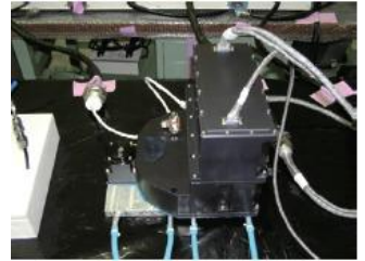
STS-126ミッションでISSに運ばれる氷結晶成長実験用セル
