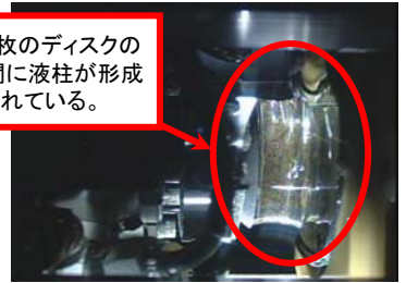
マランゴニ対流実験の液柱の様子 (側面から撮影) (©JAXA/諏訪東京理科大学)
