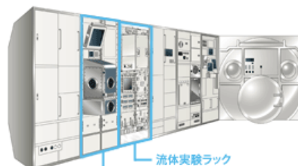
「きぼう」船内実験室の実験ラックの配置 流体実験ラック 細胞培養実験ラック
