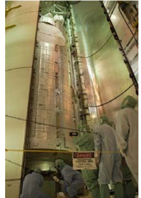
「きぼう」船内実験室とロボットアームを搭載し、ドアを閉じるディスカバリー号のペイロードベイ(貨物室) (提供:NASA)
