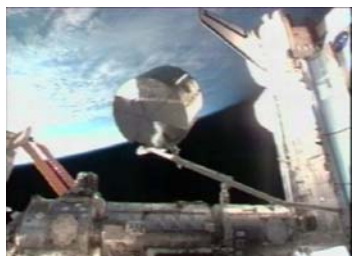
ペイロードベイ(貨物室)からISSへ移動する船内保管室(飛行4日目)
