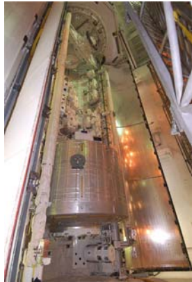
船内保管室等を搭載し、ドアを閉じるエンデバー号のペイロードベイ(提供:NASA)
