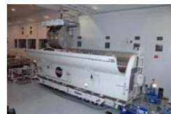
ペイロードキャニスターに収納される「きぼう」船内保管室 (提供: NASA)
