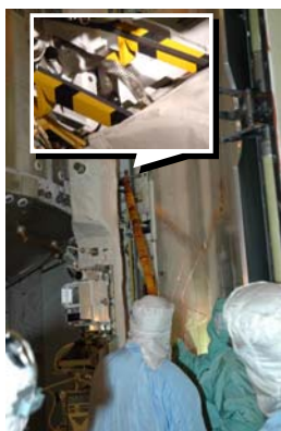
棒状の道具を使ったラジエターホースの収納作業(提供:NASA)
