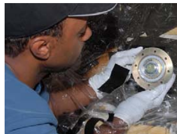
液体水素タンクとオービタ間の電気コネクタを取り外すNASAのエンジニア (提供:NASA)
