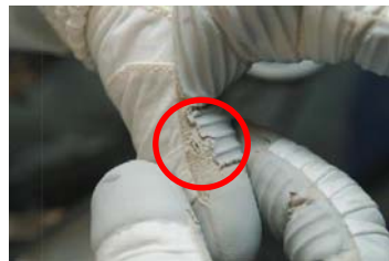
第3回船外活動中に確認されたグローブの損傷
