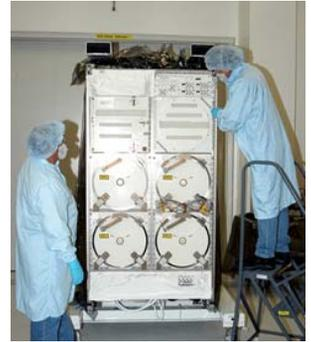
ISSの冷凍冷蔵庫MELFIの概観
