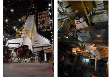
スペースシャトル組立棟でのアトランティス号の結合作業の様子(提供: NASA)
