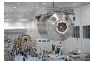
輸送用のキャリアから取り出されるコロンバス(SSPF内)(提供:NASA)
