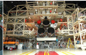
3基のスペースシャトルメインエンジン(SSME)が取り付けられた状態
