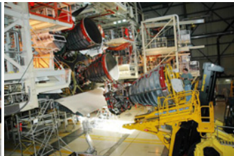
リフトで取付位置まで慎重に運ばれる第3メインエンジン
