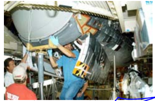
RCCパネル設置の様子
