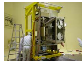
1600m³音響試験設備に設置 される生命科学グローブボ ックス
