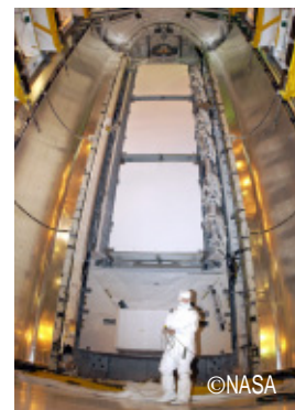
アトランティス号の貨物室に搭載されたS1トラス（KSCにて）
