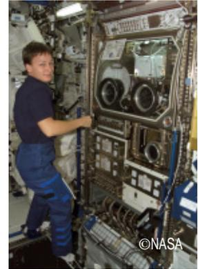
デスティニー内に設置されているグローブボックス（実験装置）
