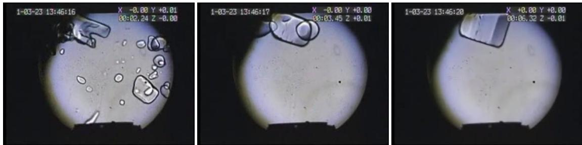
パラボリック飛行で微小重力になった瞬間に、超音波パルスにより固体ヘリウムを粉碎し、その後の時間発展を写真でとらえたもの。左から右まで 3 秒程度である。この間にオストワルド熟成が起こっていることがよく分かる。円形の窓のサイズは 24mm である。
