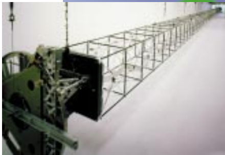
宇宙でのばす長さ60mのマスト（さお） 宇宙空間でのばす構造物としては過去最長
