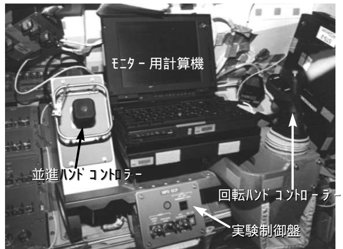
図5 - 2 組立後の MFD ワークステーション(NASA 提供)
