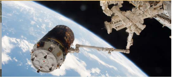
ISSのロボットアーム (SSRMS) で把持 (出典: JAXA/NASA)
