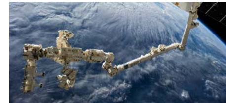
ISSのロボットアームの先端に取り付けられた「デクスター」（特殊目的ロボットアーム）
