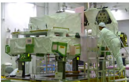
「こうのとりの」5号機の曝露パレットに搭載されたCALET (撮影場所: 種子島宇宙センター)
