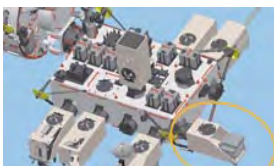
「こうのとりの」5号機の曝露パレットに搭載されたCALET (撮影場所: 種子島宇宙センター)
