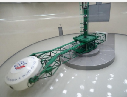
↑遠心加速器を使用したソユーズ宇宙船のマニュアル操作での帰還訓練 （出典：油井宇宙飛行士のツイッターより）
