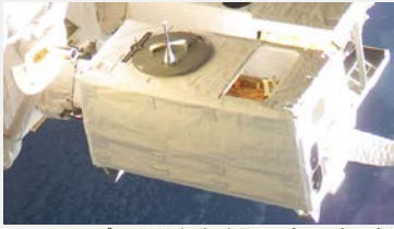
JEM-GLIMSが収められているポート共有実験装置（MCE）（出典：JAXA/NASA）
