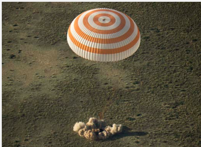
着地の直前、ソユーズ宇宙船の帰還カプセルが地上約80cmで衝撃緩和ロケットを噴射する様子（出典：JAXA/NASA/Bill Ingalls）
