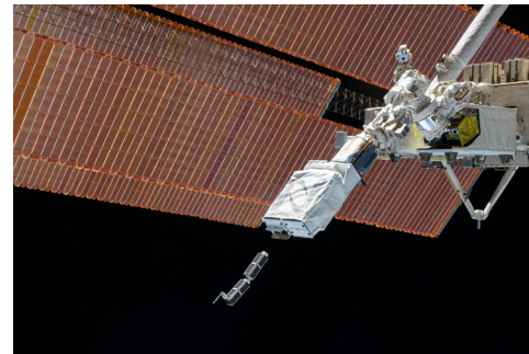
ナノラックス社製の衛星放出機構から放出される超小型衛星（サイズは3U（10cm×10cm×30cm）） (出典: JAXA/NASA)
