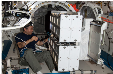
「きぼう」のエアロックでナノラックス社製の衛星放出機構をMPEPに取り付ける若田宇宙飛行士 (出典: JAXA/NASA)
