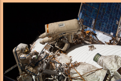
「ズヴェズダ」(ロシアのサービスモジュール)に高精度地球撮影用TVカメラを設置するオレグ・コトフ(右)、セルゲイ・リザンスキー両宇宙飛行士 (出典: JAXA/NASA)
