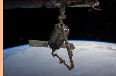
若田宇宙飛行士が操作するISSのロボットアーム（SSRMS）により「ハーモニー」（第2結合部）に結合されるシグナス補給船（Orb-1）（1月12日）（出典：JAXA/NASA）
