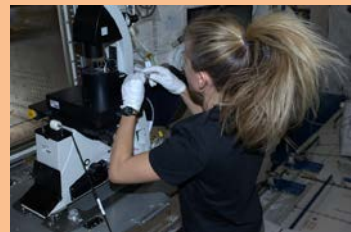
Aniso Tubule実験に備え、多目的実験ラック (MSPR) に蛍光顕微鏡を設置するカレン・ナイバーグ宇宙飛行士 (出典: JAXA/NASA)
