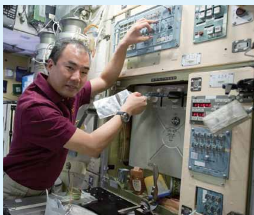
お湯・水を注入する装置。お湯の温度は80度程度。
