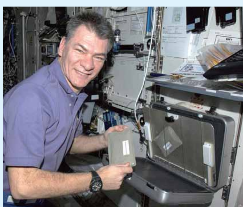
調理設備にある専用のオープン。電熱線を貼った鉄板ではさんでレトルト食品を温める。
