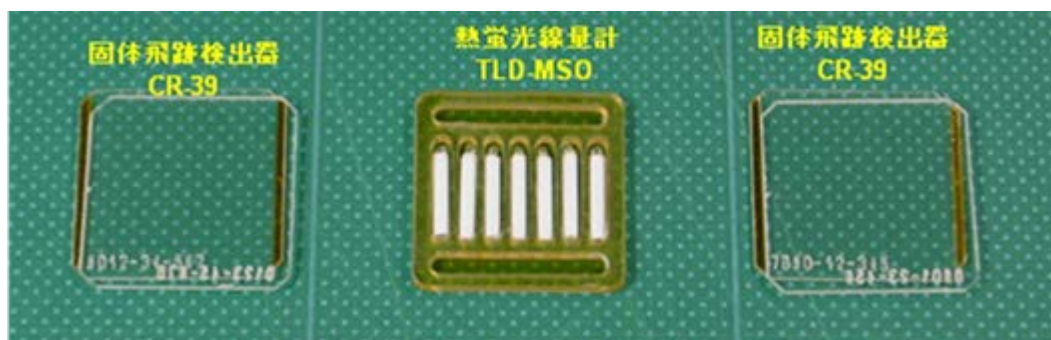
図 2.3-1 PADLES ドシメーターパッケージを構成する素子 (CR-39、TLD)
