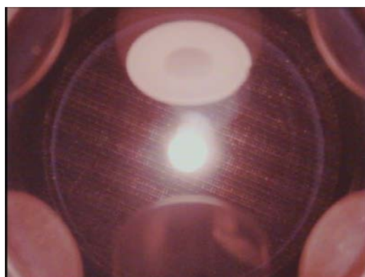
図 3.2-1 静電浮遊炉での浮遊と加熱
