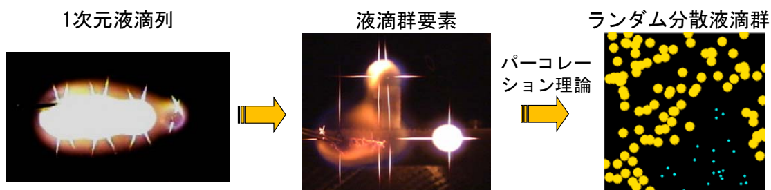
図 7-1 少数液滴燃焼から噴霧燃焼への接続概念（Group Combustion）
