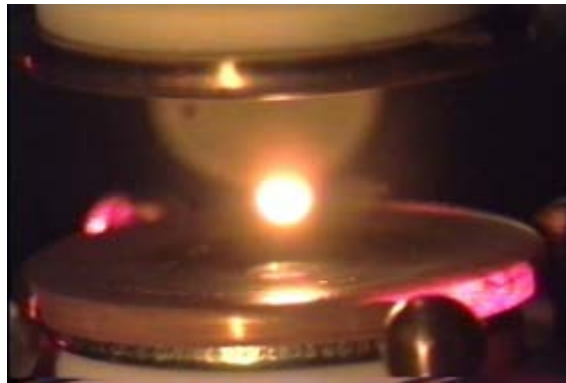
図 3.5-1 地上静電浮遊炉での浮遊と加熱
