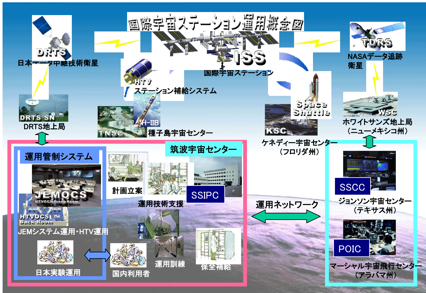
図 1.3-6 「きぼう」運用システムの概要
