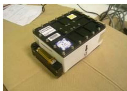
図3. 高品質タンパク質結晶生成用セルユニット
