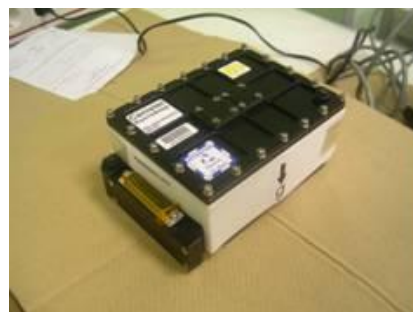
図5. 高品質タンパク質結晶生成用 セルユニット (High Quality Protein Crystal Growth Experiment Canister)
