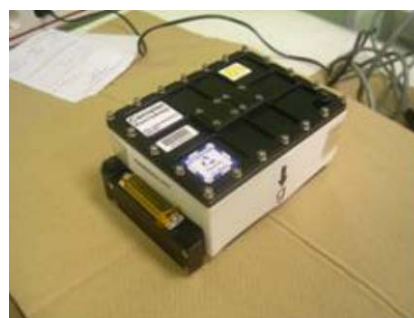
図5. 高品質タンパク質結晶生成用 セルユニット (High Quality Protein Crystal Growth Experiment Canister)
