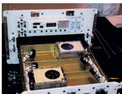
図4. タンパク質結晶生成装置 (Protein Crystallization Research Facility; PCRF)
