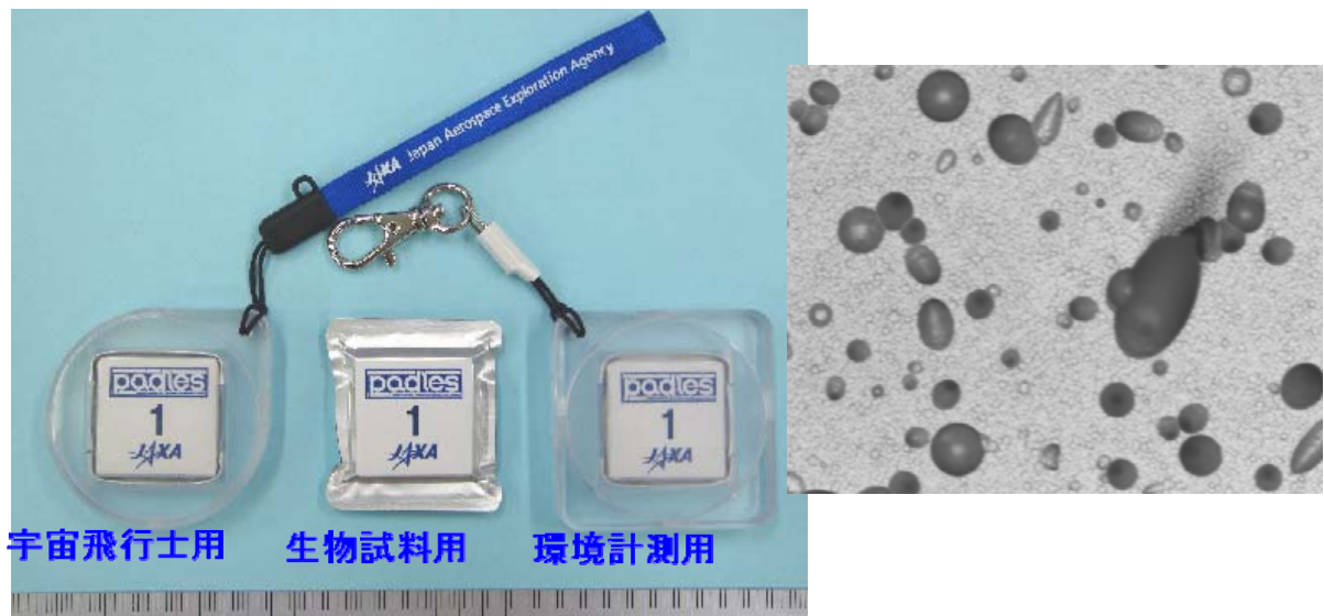
図 2.6-2 (左)PADLES ドシメーターパッケージには用途に応じて、素子をアルミヒートシール(3cm×3cm×0.5mm)で封入したもの、ポリカケース入りのものがある(4.6cm×4.6cm×0.9mm)。 (右) ISS「きぼう」船内に 278 日間搭載された固体飛跡検出器 CR-39。軌道上で線量計を通過した重荷電粒子の飛跡(エッチピット)を可視化して見ることができる。このエッチピットの形状、個数を測定することで LET 分布を算出できる。
