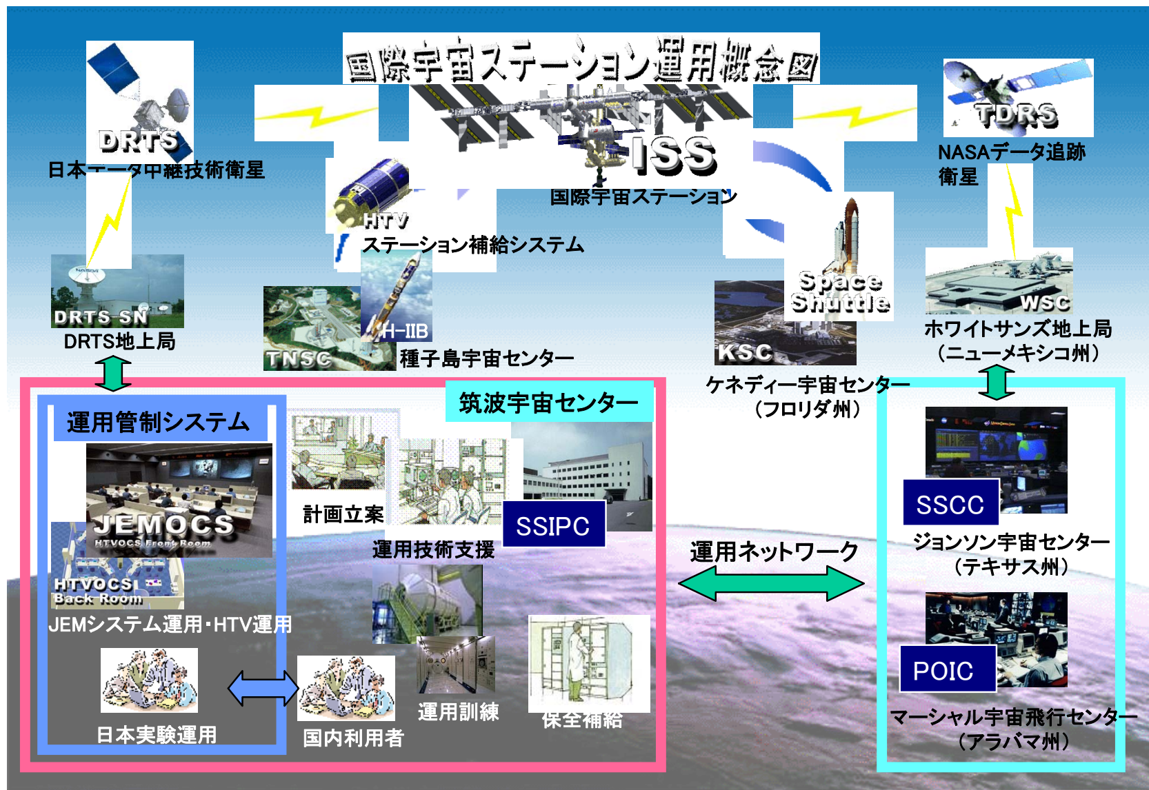
図 1.3-6 「きぼう」運用システムの概要
