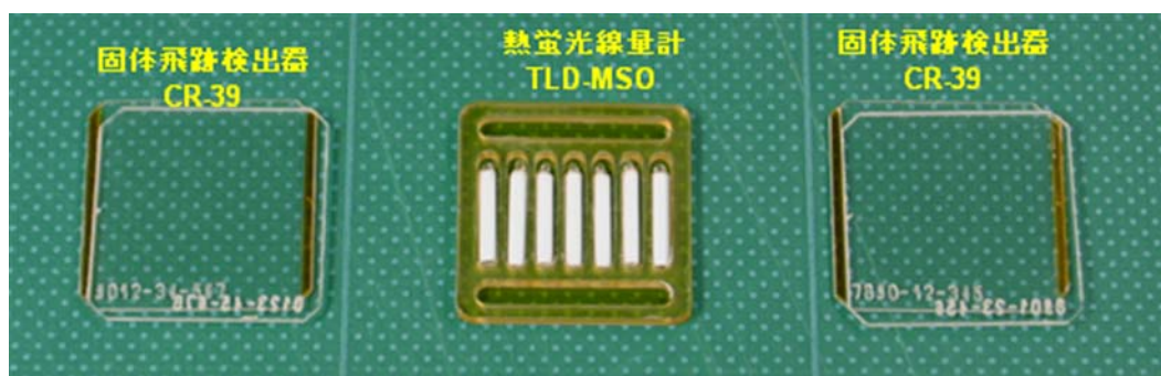
図 2.6-1 PADLES ドシメーターパッケージを構成する素子 (CR-39、TLD)
