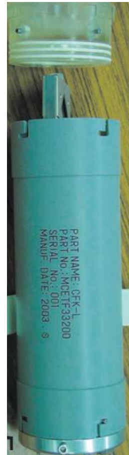
図 2.1.1-4 細胞固定器具（CFK）
