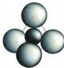
ダイヤモンド結晶格子ユニット (正四面体型会合体)
